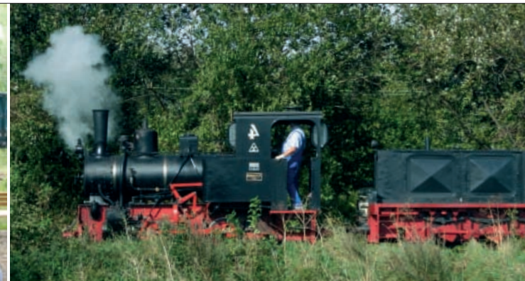
Achim Schell (l.) ist stolz auf „seine Kinder“ im Feld- und Werksbahnmuseum Oekoven. Das alte „Dampfross“ ist die 65 PS starke Lok Nr. 4 der Firma Jung aus Jungental aus dem Jahre 1941. Sie war früher für den Autobahnbau und die Moselregulierung im Einsatz.
