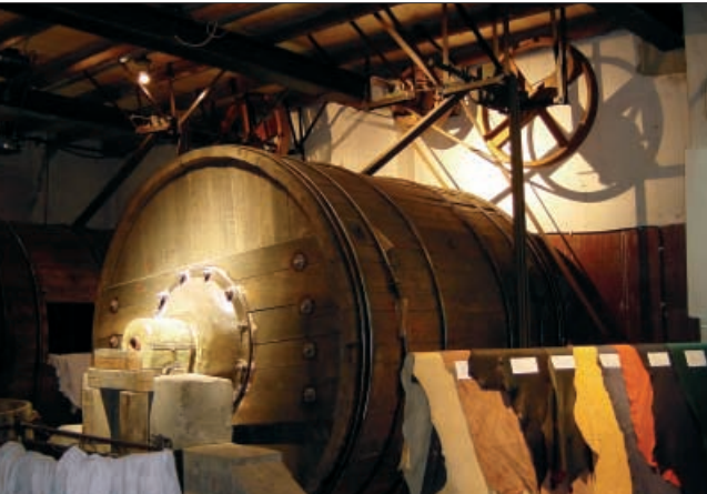
Markanter Blickfang in der Gerberei Sasse in Enger sind die Weich- oder Äscherfässer zum Einweichen und Entfernen der Tierhaare.
