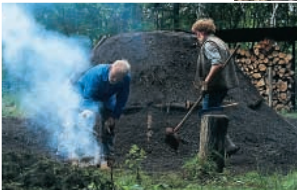
Hier wird der Hauberg wieder lebendig: In einem mit Erde luftdicht abgeschlossenen Meiler wird aus Holz Holzkohle.
