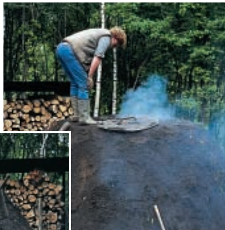
Hier wird der Hauberg wieder lebendig: In einem mit Erde luftdicht abgeschlossenen Meiler wird aus Holz Holzkohle.
