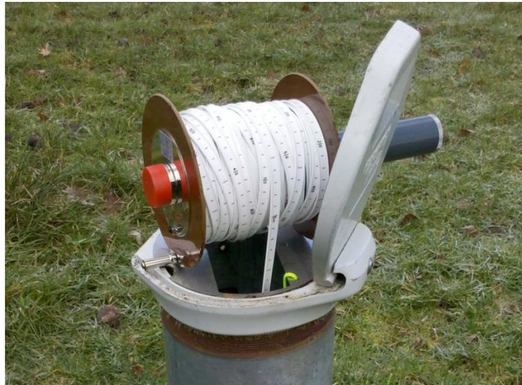
Abb. 15: Grundwasserstandsmessung (Quelle: LANUV NRW).
