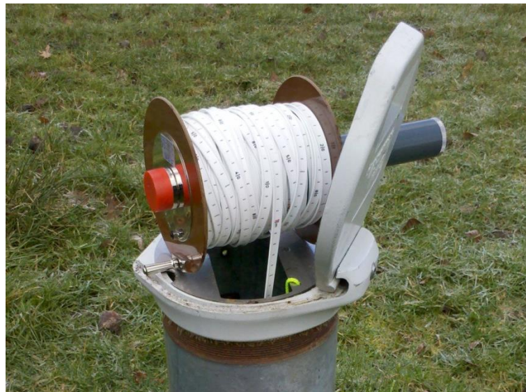
Abb. 18: Grundwasserstandsmessung (Quelle: LANUV NRW).
