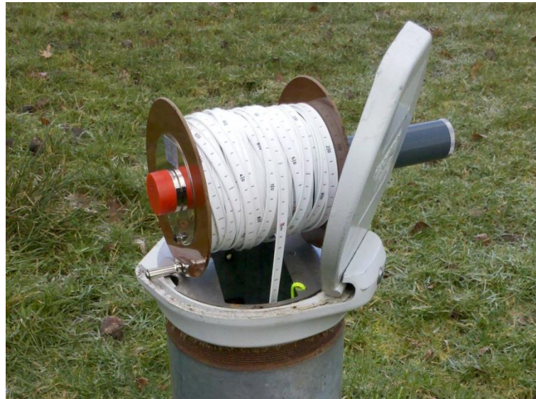
Abb. 18: Grundwasserstandsmessung (Quelle: LANUV NRW).
