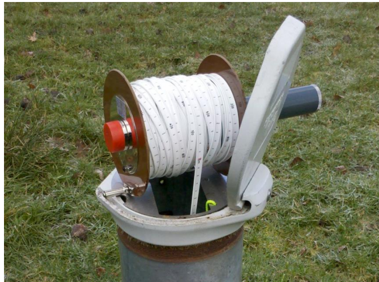
Abb. 16: Grundwasserstandsmessung (Quelle: LANUV NRW).
