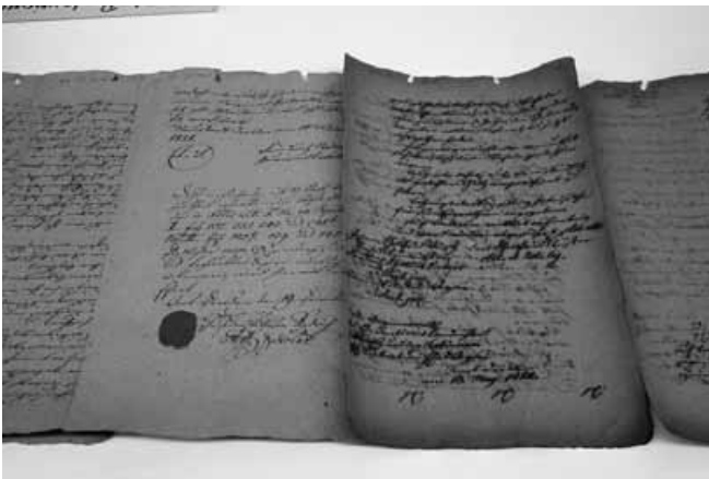
Abb. 5: Alterungstests mit Kassationsmaterial, links gewässerte Blätter, rechts ungewässerte Blätter nach der künstlichen Alterung. Foto: Sächsisches Staatsarchiv, Ulrike Müller
