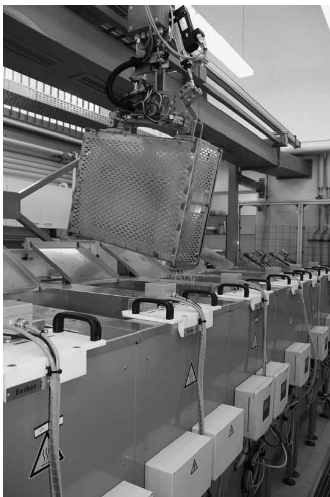
Abb. 4: Papiernassbehandlungsanlage, Herausheben einer Kassette aus dem Becken während des Wässerungsvorganges, Foto: Sächsisches Staatsarchiv, Ulrike Müller
