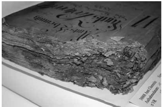
Abb. 3: Schimmelschaden an einer Akte, mit stark abgebautem Papier und großem Fehlstellenbereich, Signatur 2600, 30008 Amt Chemnitz, Foto: Sächsisches Staatsarchiv, Ulrike Müller
