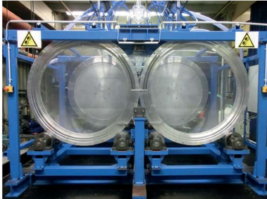
*Plexiglasmodell einer Bandgießanlage im BFI. Die Schmelze fließt zwischen zwei gegenläufig rotierenden gekühlten Rollen und erstarrt zu einem dünnen Band.*
