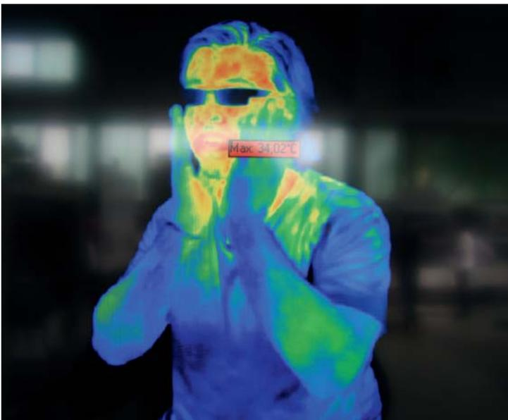
Am Tag der Offenen Tür des Stahl-Zentrums probierten Besucher die BFI-Wärmebildkamera aus. Sie überwacht gewöhnlich die Wärmeentwicklung an Industrieanlagen und erkennt Temperaturschwankungen von bis zu 0,05 Grad.
