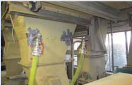
Bei einem Produktionsprozess hatte sich das Futtermittel im Silo entzündet. Da eine Staubexplosion drohte, wurde das Silo mit Stickstoff geflutet und damit der Brand erstickt. Die Löscharbeiten unterstützte eine hinzugerufene Spezialfirma aus Dortmund. Um an die Glutnester zu gelangen, mussten Teile der Anlage demontiert werden. Am späten Abend waren dann auch die letzten Glut-
