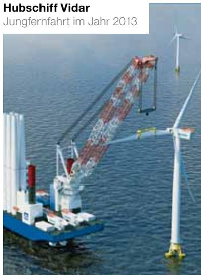
„Vidar“ ist der jüngste Zugang zur HOCHTIEF-Flotte: Das neue Schwerlast-Kranhubschiff für die Montage- und Wartungsarbeiten an Offshore-Anlagen der neuesten Generation kann in Wassertiefen von bis zu 50 Metern arbeiten. Es ist auf einer Länge von 136,5 Metern mit einem 1 200-Tonnen-Kran und einer Ladekapazität von 6 500 Tonnen aus-
