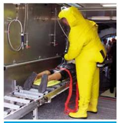
Die Vielseitigkeit des Abrollbehälters zeigt sich auch darin, dass nur ein Transportsystem aufgebaut werden kann und die zweite Kabine für gehfähige verletzte Personen zur Verfügung steht. Ebenso kann der Abrollbehälter bei alltäglichen ABC-Lagen zur Dekontamination der Kräfte verwendet werden, die unter ABC-Schutzkleidung eingesetzt waren.
