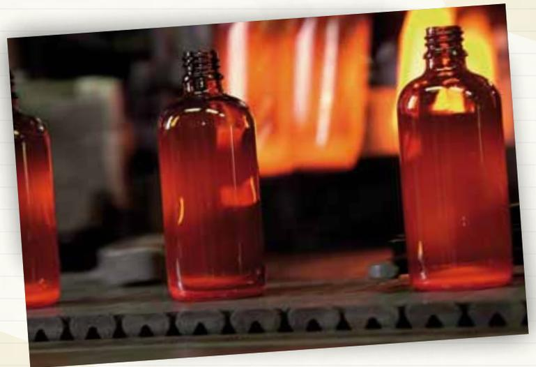
Zweistufiges Verfahren zur Herstellung von Ampullen, Injektionsfläschchen und Karpulen
