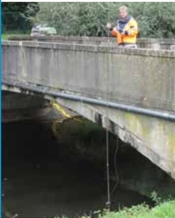
Frank Sandig bei einer Abflussmessung mit dem Messgestänge am Pegel.
