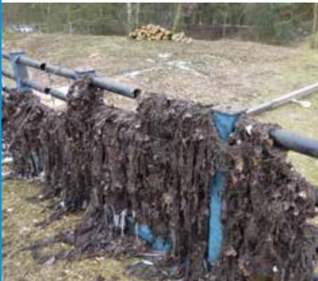
Kläranlage Walbeck: Teil des alten Belüftungssystems mit Verzopfungen
