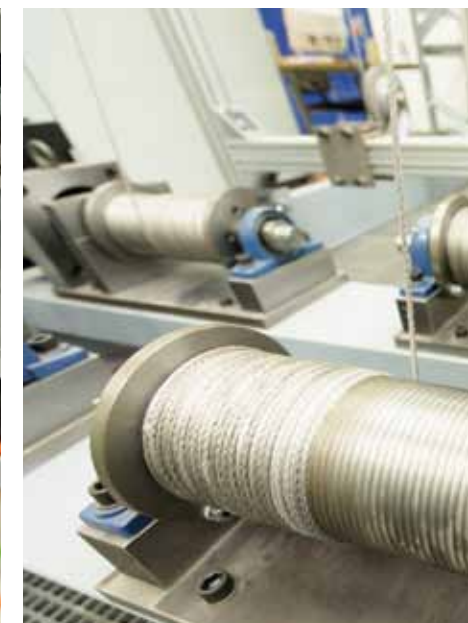
Förderbänder schieben die Ware ins Regal (l.). Glänzende Winden verhindern, dass sich die Seile verheddern. Dr. Tobias Bruckmann kennt sich mit Seilrobotern aus (r.).
