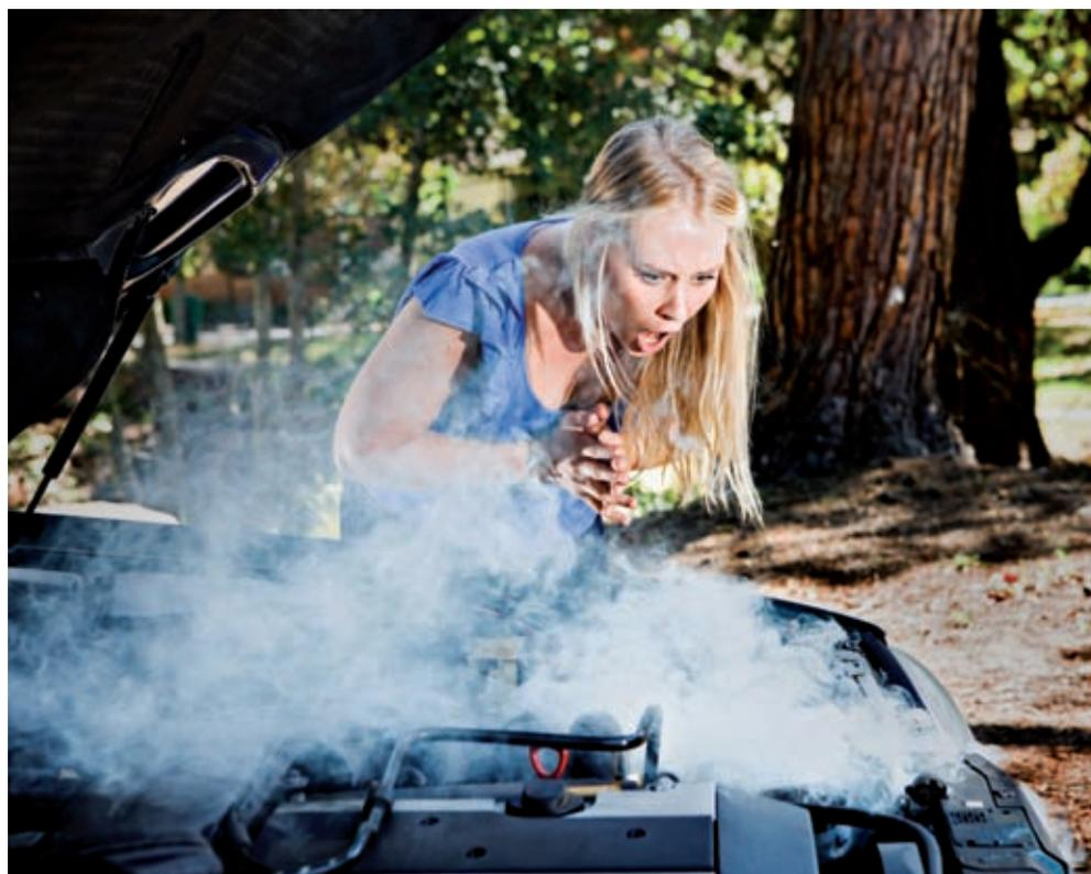
**Bei Kühlerdefekt:** anhalten, Motor abstellen, Motorhaube öffnen!
