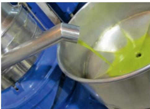
**Unter Ausschluss von Sauerstoff** werden die Oliven bei 24 °C bis maximal 27 °C „kalt gepresst“.
