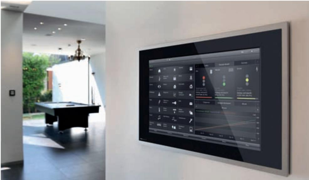
**Intelligente Gebäudetechnik hilft beim Energiesparen.** Das sogenannte KNX/EIB-System ermöglicht ein Energiemanagement, das exakt auf die Bedürfnisse der Bewohner ausgerichtet ist. Steuern lässt sich die Haustechnik beispielsweise über den Gira Control 19 Client.
