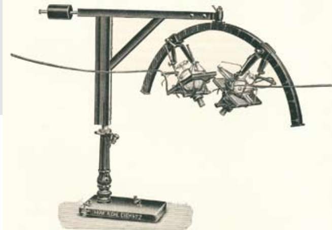
Friedrichs und Knippings Experiment zum Nachweis der Beugung und Interferenzen der Röntgenstrahlen
