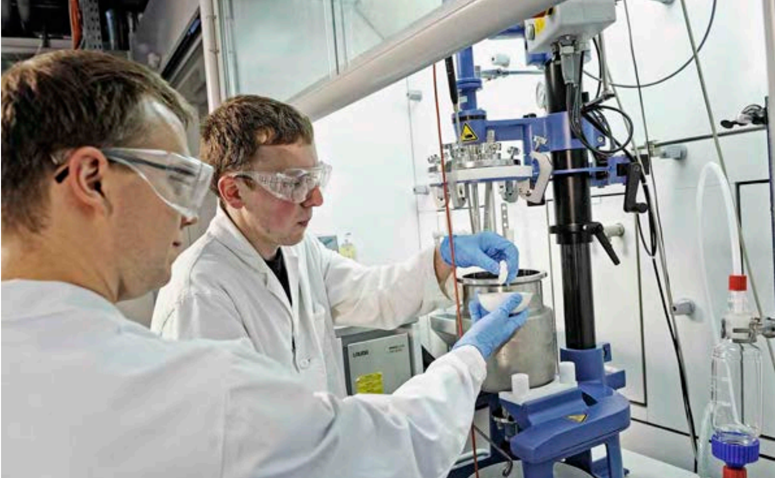
Im Rührautoklav stellen die Masterstudenten Florian Merkel und Volker Bliem Gashydrate her. Diese sehen aus wie Eisschnee (unten rechts) - und brennen ganz vorzüglich, wenn sie angezündet werden.
