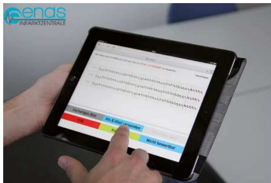
Die vom ISST entwickelte Software übermittelt die EKG-Daten des Patienten vom Krankenwagen aus an die Infarktzentrale, die diese wiederum direkt auf das Tablet oder Smartphone des Herzspezialisten im Zielkrankenhaus senden
