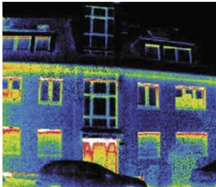
Abb. 9 | Thermografieaufnahmen eines ungedämmten (links) und eines gedämmten (rechts) Wohnhauses
