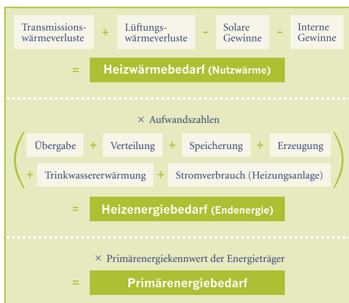
Abb. 32 | Vereinfachtes Schema der energetischen Bilanzierung nach der EnEV
