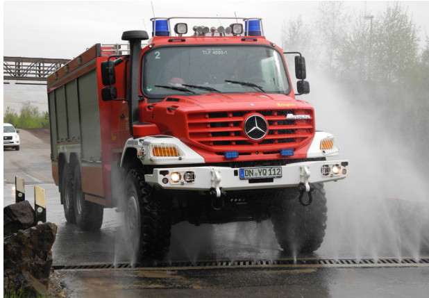
Bild 5.5 – Reinigungsstrecke an der Tagebauausfahrt.
