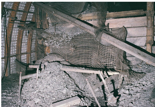
Bild 4.1 – Bohrlochfuß mit zerstörtem Ladekasten nach dem Zündereignis
