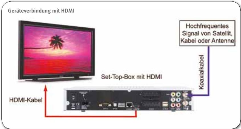
nicht um einen üblichen Antennenstecker, wie er zum terrestrischen oder TV-Kabelnetz-Empfang verwendet wird, sondern um eine Steckverbindung mit Schraubverriegelung, die besonders für die hohe Frequenz des Sat-ZF-Signals ausgelegt ist. Das Koaxialkabel
