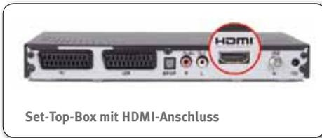
(Flatscreen) oder ein Videoprojektor (Beamer) angeschlossen werden. Viele Flatscreens verfügen bereits über spezielle Module (DVB-T-Tuner), von denen die digitalen Signale direkt in Bilder und Töne umgewandelt werden können, sodass keine Set-Top-Box erforderlich ist. Dies gilt bei neu auf den Markt kommenden Flachbildschirmen grundsätzlich für alle TV-Monitore mit einer Bildschirm-diagonalen von mindestens 32 Zoll.
