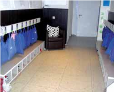
Flur mit freigehaltenem Fluchtweg
