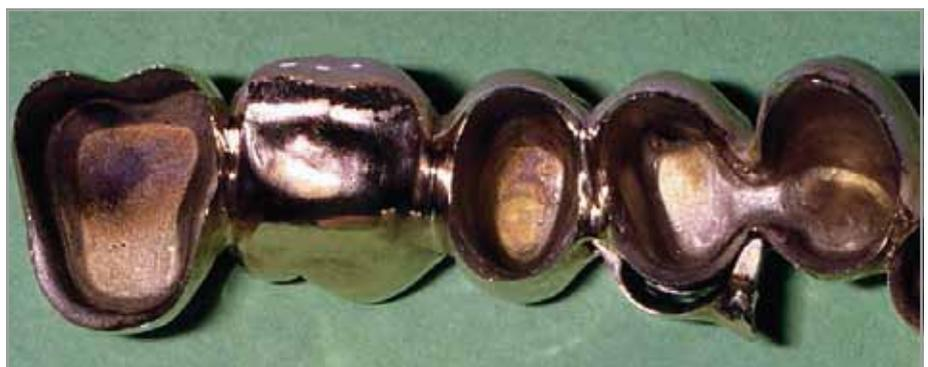
Abb. 5: Verriegelte abnehmbare Brücke im Oberkiefer aus hochgoldhaltiger Legierung (Degulor M) 12 Wochen nach Eingliederung mit deutlichen Spuren einer Kupferkorrosion (braunes Kupferoxid) an der Innenseite der Außenteleskope. Grund: Lokalelementbildung durch bakteriell verursachte pH-Wert-Unterschiede zwischen Speichel in der Mundhöhle (pH = 6,2 bis 6,8) und im Spalt zwischen Außen- und Innenteleskop (pH < 3).
