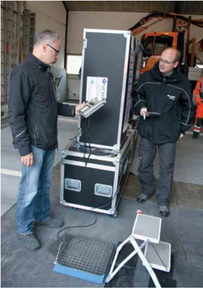
Christian Fritsch und Sebastian Rabe bereiten die nächste Station vor: Ein Mitarbeiter stellt sich auf die Trittleiter und springt auf den Boden. Im normalen Arbeitsalltag entspricht dies der Situation, wenn das Fahrzeug verlassen wird. Hier wird das Aufprallgewicht gemessen, das die Mitarbeiter erraten sollen. Mehr als 200 kg wurden registriert, die auf die Gelenke wirken. Auch das sensibilisiert.
