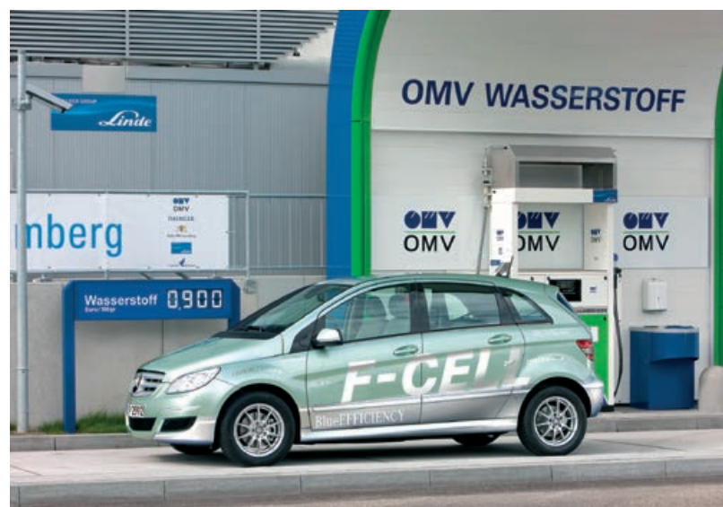
Abbildung 4.10: Mercedes-Benz B-Klasse F-CELL (80-kW-PEM-Brennstoffzelle, 100-kW-Elektroantrieb, Li-Ion-Batterie für 30-kW-Leistung, ca. 400 km Reichweite, Druckwasserstoff-Speicher (700 bar), Verbrauch 103 MJ/100 km oder 2,9 l Diesel-Äquivalent pro 100 km) (Quelle: Daimler AG)
