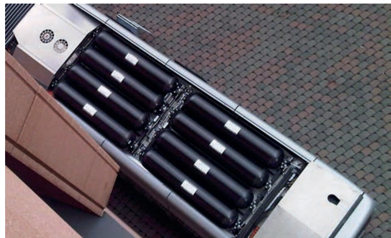
Abbildung 3.4: Wasserstofftanks auf dem APTS-Phileas Brennstoffzellenbus der RVK (350 bar, Typ-3-Behälter mit Aluminium Liner, 8 x 205 Liter) (Quelle: Dynetek Europe GmbH)
