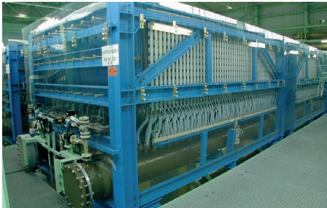
Abbildung 2.7: Chlor-Alkali-Elektrolyse in Hürth-Knapsack: 310.000 t Chlor pro Jahr, 203.000 Nm 3 Wasserstoff pro Tag; 2 \text{ NaCl} + 2 \text{ H}_2\text{O} \Rightarrow 2 \text{ NaOH} + \text{Cl}_2 + \text{H}_2 (Quelle: HyCologne)
