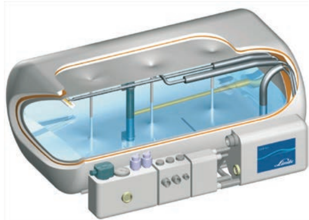
Abbildung 3.5: Schnitt durch einen Flüssigwasserstoffspeicher (Quelle: Linde AG)
