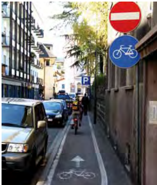
Notlösung: Radweg zulasten des Fußverkehrs
