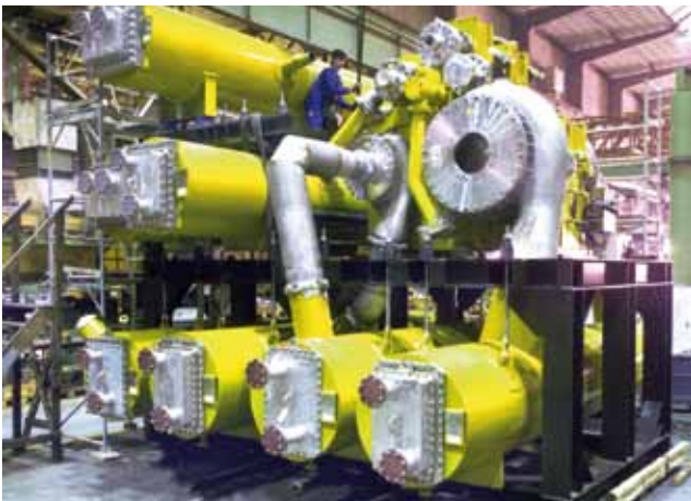
Produktion von Düngemitteln: Erster zehnstufiger Getriebekompressor der Welt für die Harnstoffsynthese
