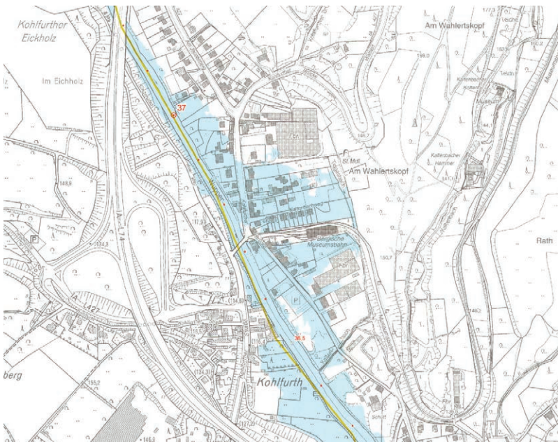
Ausschnitt aus einer Überschwemmungsgebietsdetaillkarte der Wupper, in welcher Überschneidungen zwischen Überschwemmungsgebiet und baulicher Nutzung zu erkennen sind.
