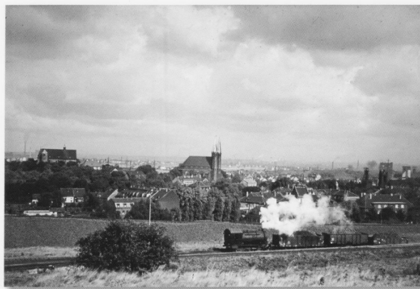
1957, Blick über Stoppenberg. Die feuerlose Lokomotive stand unter hohem Dampfdruck der etwa 8 Stunden Fahrtbetrieb sicherstellte. Eine Betriebsart, die besonders für den Transport in explosionsgefährdeten Bereichen geeignet war.
