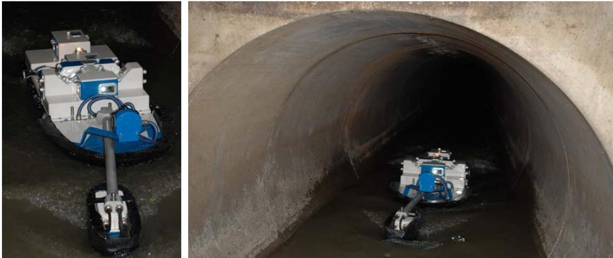
Bild 4-8: Inspektions- und Reinigungssystem für den Abwasserkanal Emscher
