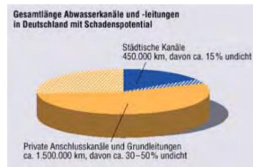
Abb.1: Anteil undichter Abwasserkanäle in Deutschland
