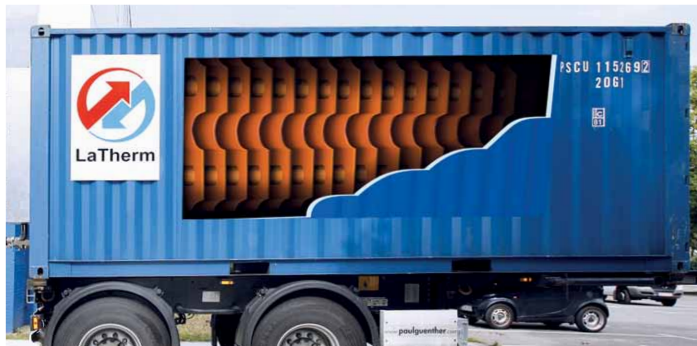
Beim Projekt „Wärme auf Rädern“ wird ungenutzte Industrieabwärme in Containern gespeichert und zu größeren Wärmeverbrauchern transportiert.
