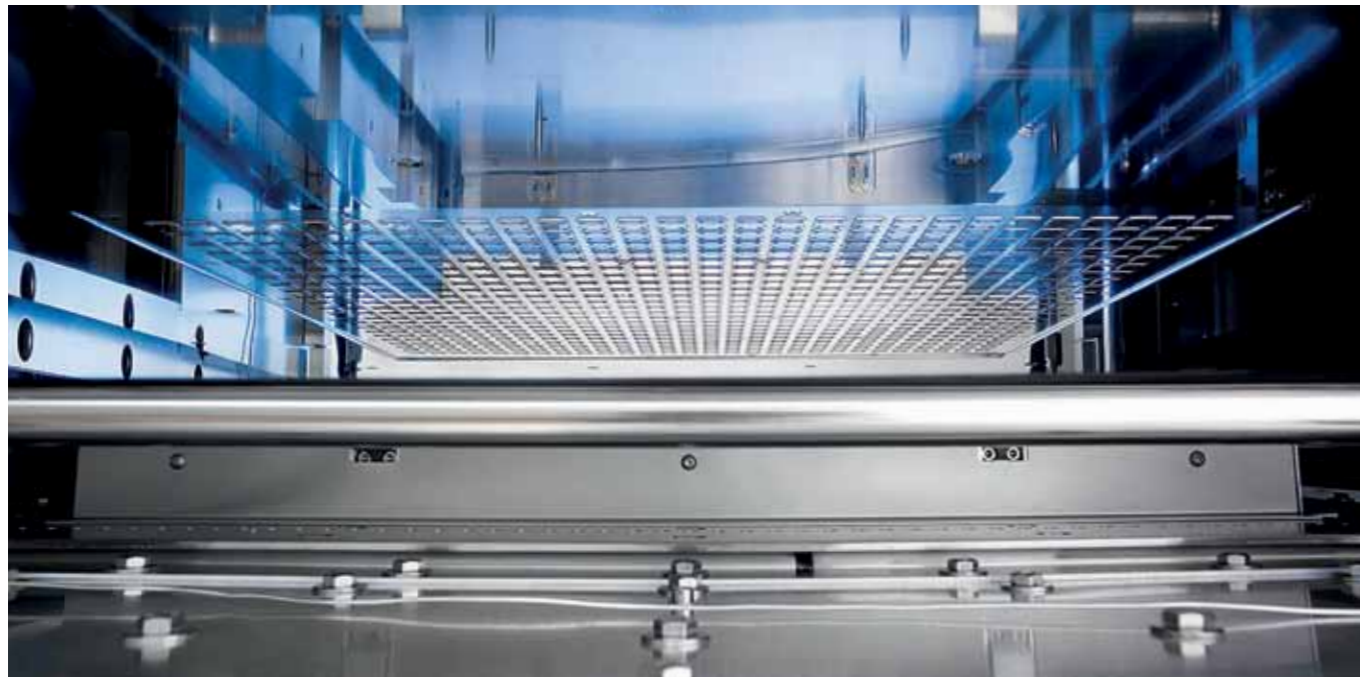
Die AIXTRON-OVPD(R)-Anlage stellt organische Materialien her, die anschließend in OLEDs und organischer Elektronik zum Einsatz kommen.
