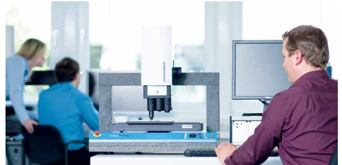
Der 3D-Profilometer „µscan explorer“ ermöglicht die berührungslose Oberflächenanalyse im Mikro- und Nanometerbereich.
