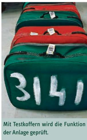
Mit Testkoffern wird die Funktion der Anlage geprüft.
