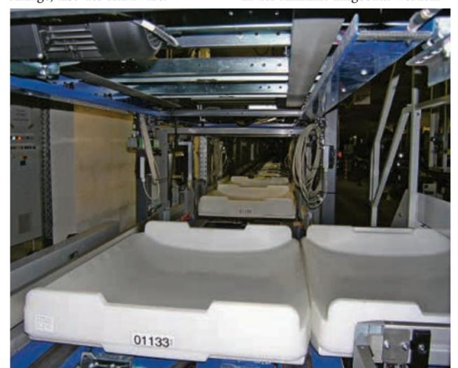
Die neue Förderstrecke wird über sieben Kilometer lang sein und aus 3.200 Förderelementen bestehen.
