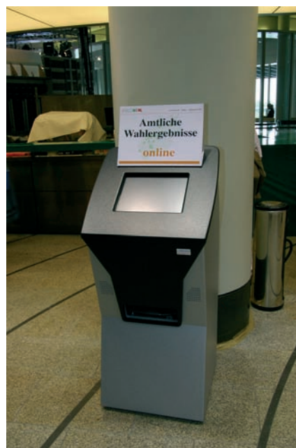
Abb. 1: Das „Kiosksystem“ mit dem berührungssensitiven Touchscreen
