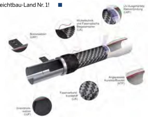
Dieser Technolgie demonstator zeigt schematisch einen symbiotischen Aufbau art-fremder Materialien in Hybridbauweise, der durch interdisziplinäre Zusammenarbeit an der Universität Paderborn realisiert werden kann. (LWF – Laboratorium für Werkstoff- und Füge-technik, LIA – Leichtbau im Automobil, LUF – Lehrstuhl für Umformende und Spanende Fertigungstechnik, KTP – Kunststofftechnik Paderborn)
