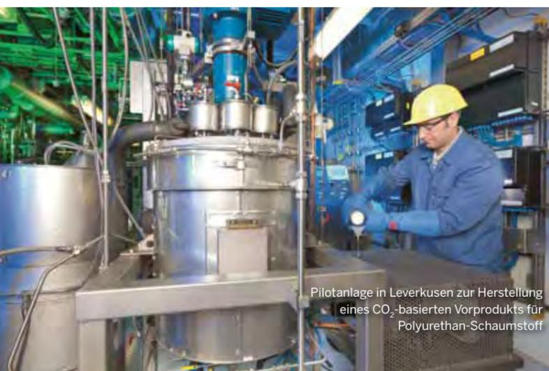
Pilotanlage in Leverkusen zur Herstellung eines CO<sub>2</sub>-basierten Vorprodukts für Polyurethan-Schaumstoff
