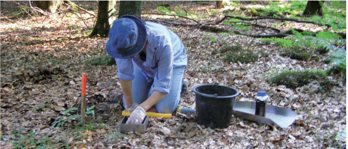
Entnahme der Humusauflage unter Verwendung von Stechrahmen
