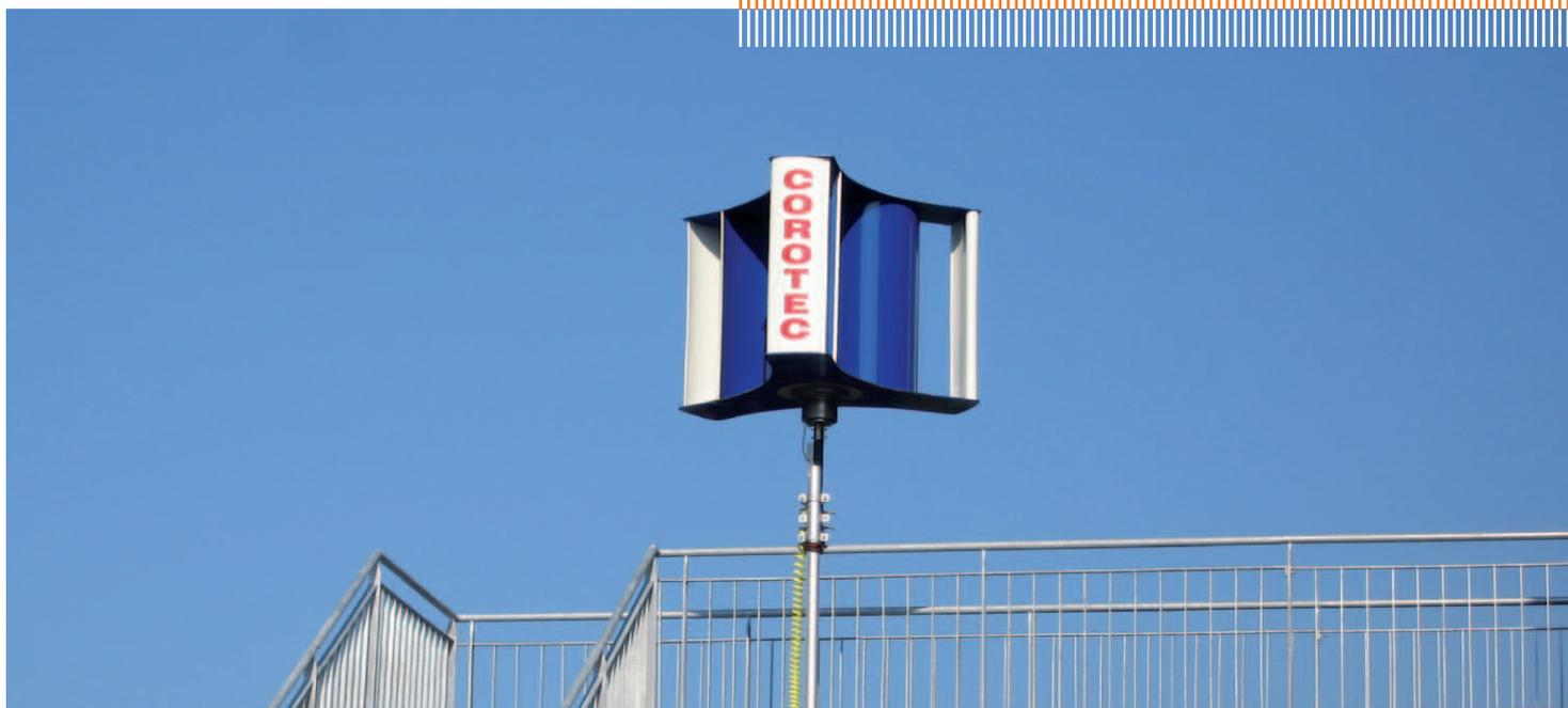
Kleine Windkraftanlage, Foto AIXBIO
