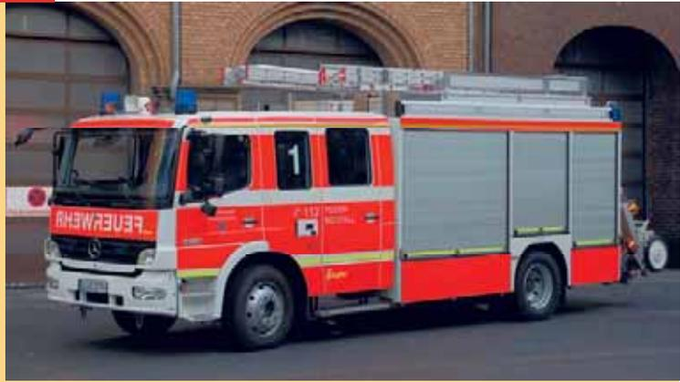
Die LF 16/12 (oben links) der FF verfügen über ein normales Allradfahrgestell und sind damit geländefähig. Die HLF 20/16 (oben rechts) der BF verfügen über ein Fahrgestell mit Hinterachsantrieb und sind für befestigte Straßen bestens geeignet.
