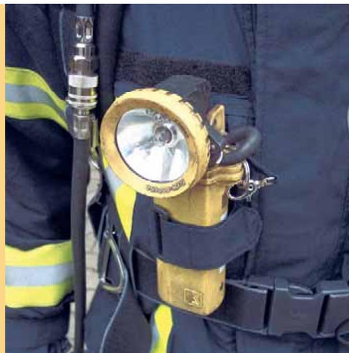
*Bild rechts: Gute Lampenbefestigung*
