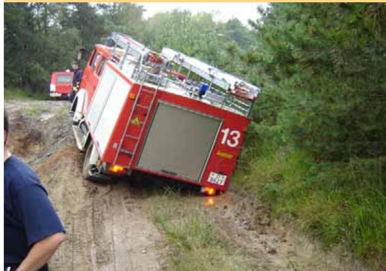
*Vor allem der hintere Überhang(-winkel) spielt im Gelände nicht nur beim An- und Überfahren von Bodenunebenheiten oder Schrägen eine Rolle, sondern auch, wenn das Fahrzeug in Spurrillen hinten seitlich wegrutscht. Das Heck schert dabei schräg aus und kann sich dann auch in Richtung einer Böschung bewegen. Deutlich ist im Bild das Wegschmieren der Hinterachse an der linken Fahrspur zu sehen. Das Heck befindet sich bereits in der Böschung.*
