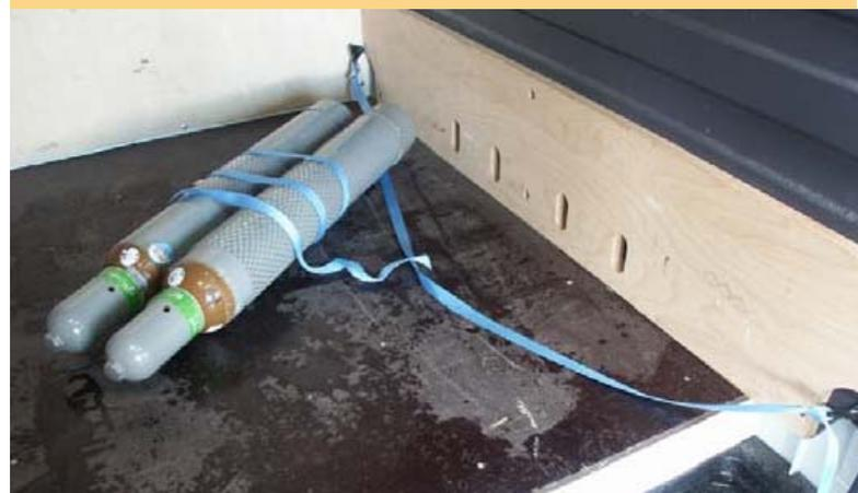
*Nicht ausreichende Sicherung mit Zurrgurten an den Befestigungspunkten*
