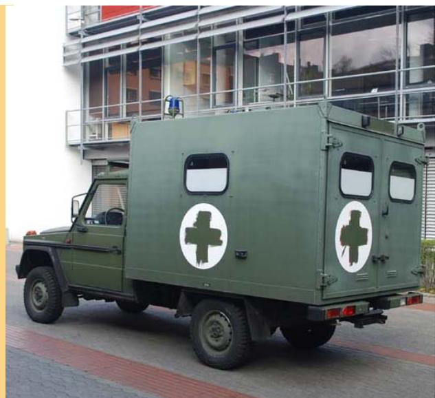
Ein während der Fahrt zuschaltbarer Allradantrieb, der nochmals in Straßen- und Geländeübersetzung unterteilt ist sowie je eine Differentialsperre für die Vorder- und Hinterachse machen dieses Fahrzeug gerade für schwieriges Gelände optimal.
