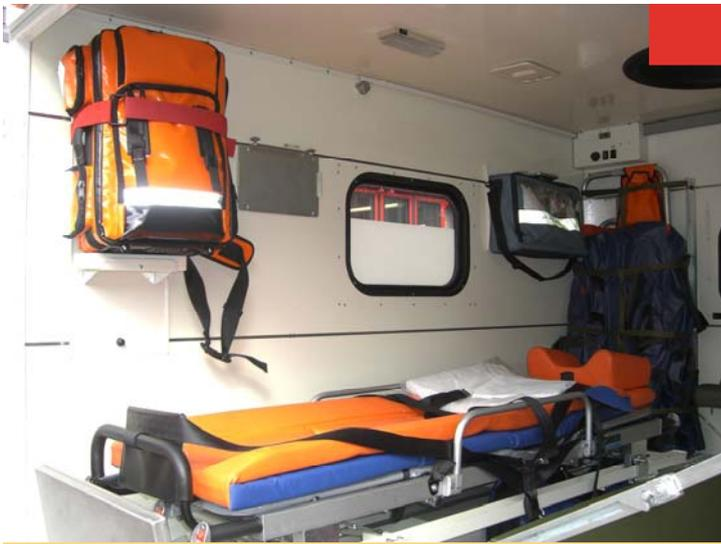
*Bild oben links: Innenraum linke Fahrzeugseite mit Notfallrucksack, direkt rechts daneben die Tragplatte für das EKG und in der Ecke die Inhalationseinheit. Natürlich wurde auch eine zeitgemäße Krankentrage eingebaut.*
