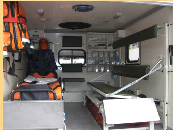
*Bild rechts: Stirnseite mit Schaufeltrage und Vakuummatratze links in der Ecke und Materialfächern an der anderen Seite. Decken und Infektionsmaterial wird unter der Klapptrage rechts gelagert.*
