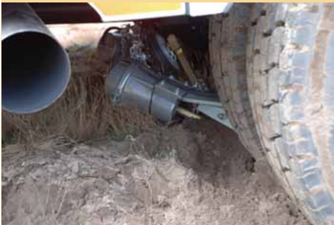
Bilder 3 und 4: Hier werden die Probleme mit den Schleuderketten im Gelände deutlich
