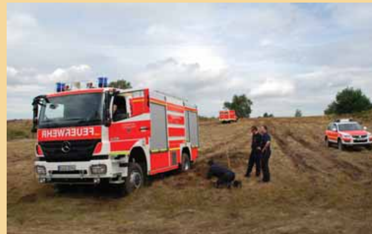
Bilder 3 und 4: Hier werden die Probleme mit den Schleuderketten im Gelände deutlich
