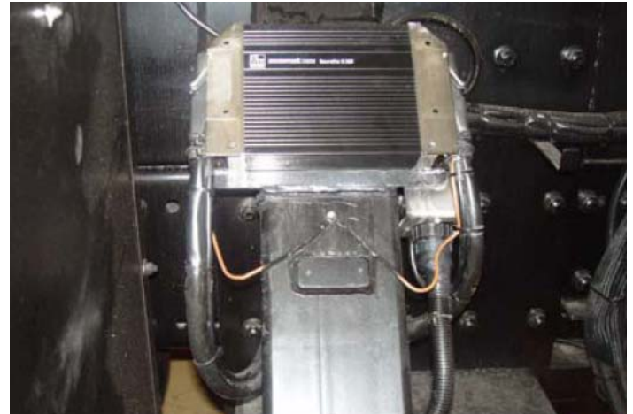
Bild 8: CAN Bus Steuergerät
