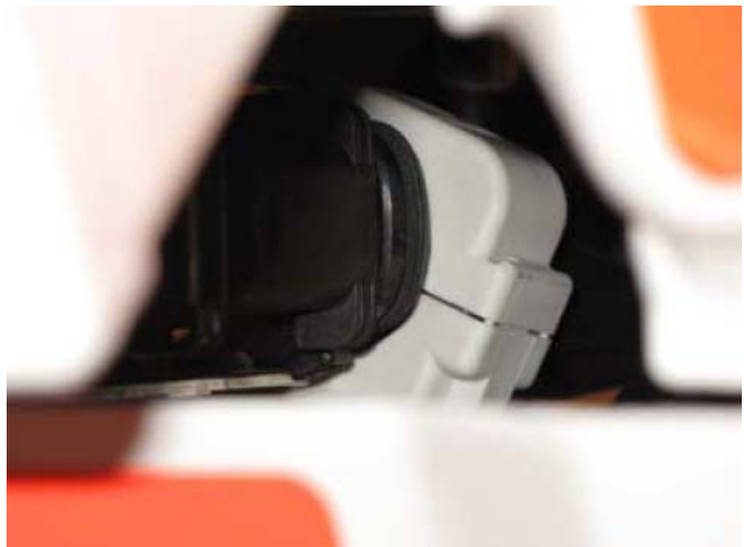
Bild 12: Ferritkerne Nähe Drehkranz/Hauptbedienstand eingebaut
