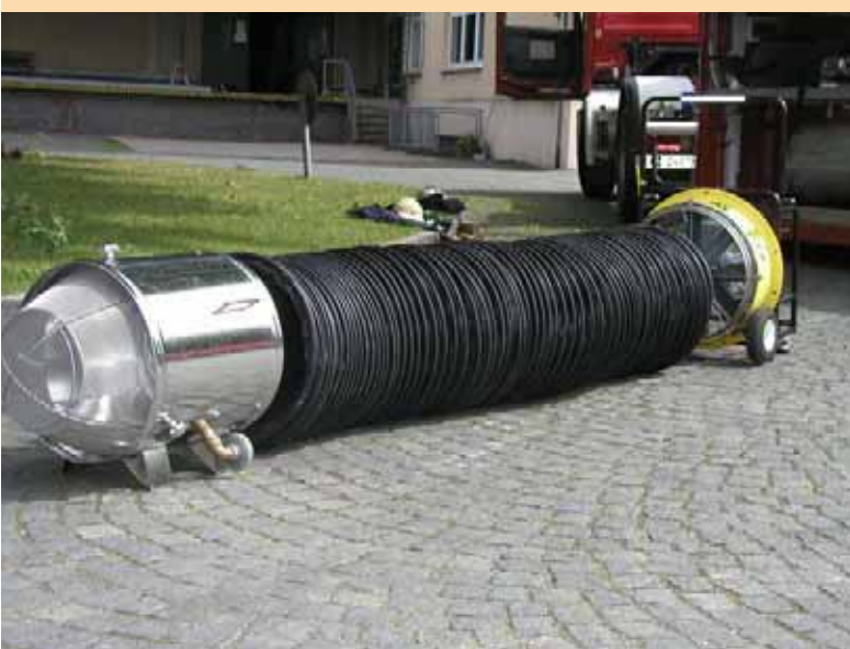
Bild 4: System zur Erzeugung von Mittel- und Leichtschäum
