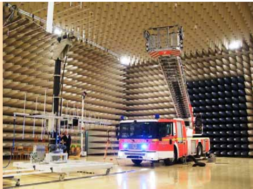
Die neue Drehleiter der FRW 7 beim abschließenden EMV-Screening in München bei Krauss-Maffei
