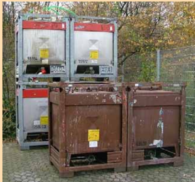
Zur Erweiterung der Übungsmöglichkeiten im Gefahrguteinsatz wurden 1000 l Container präpariert.
