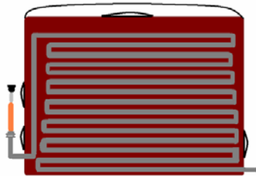
Tragetasche für zwei D-Druckschläuche mit angeschlossenem Strahlrohr. Die beiden Schläuche liegen in Buchten in der Tasche.
