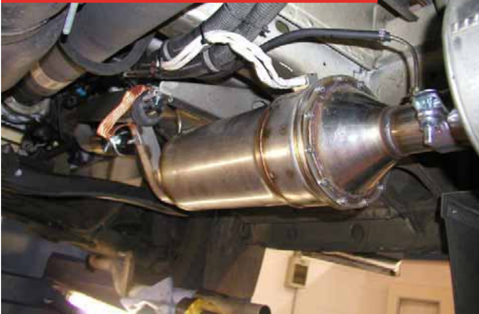
Filtereinheit, hier noch ohne das Hitzeschutzblech
