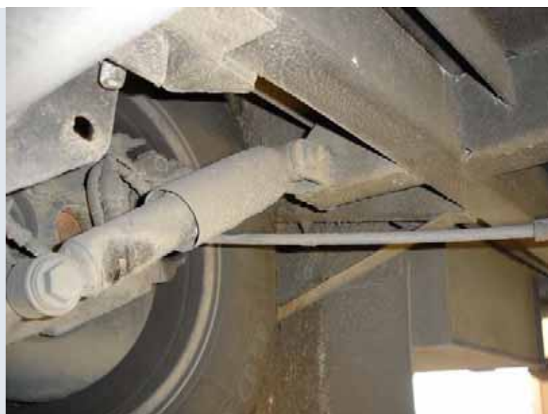
Gebrochene Stoßdämpfereaufnahme an der Hinterachse eines KTW, Aufbau KFB.
