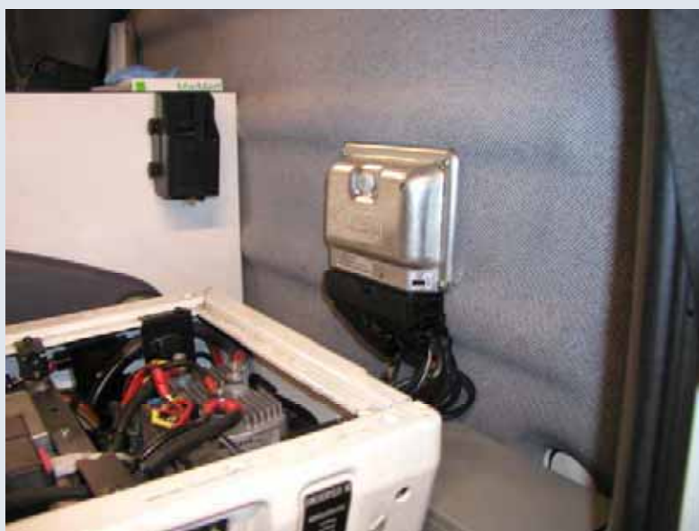
Bild unten: Das Steuergerät hinter dem Fahrersitz
