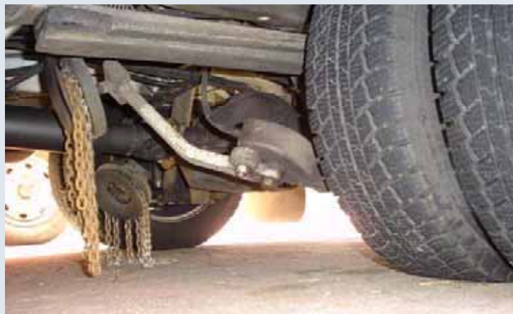
Schleuderketten hier an einem RTW. (Foto: Cimolino)
