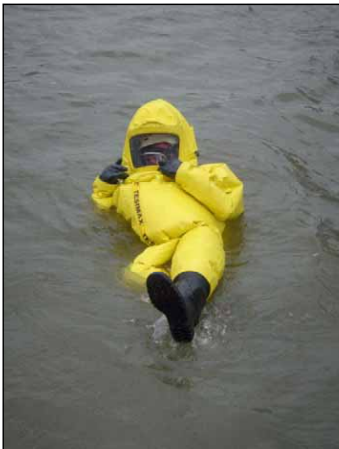
Auch unter CSA ist die Rückenlage am angenehmsten und die Auftriebskraft enorm. Die Sicht ist allerdings durch den Anzug erheblich behindert.
