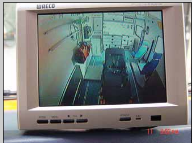
Bild oben rechts: Der S-RTW verfügt über ein Navigationsgerät und über eine Überwachungskamera des Patientenraumes.
