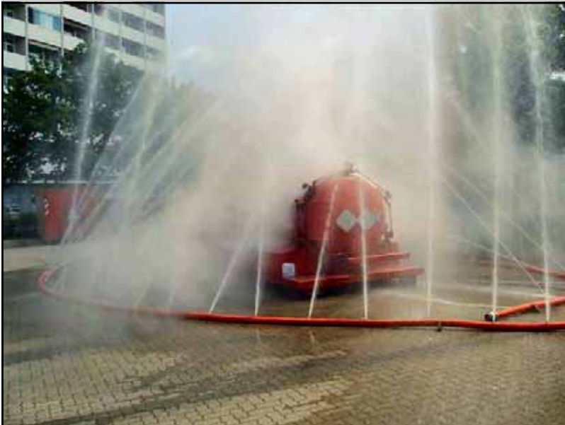
Die Fotos des Herstellers zeigen deutlich die Wirkungsweise der Düsenschläuche
