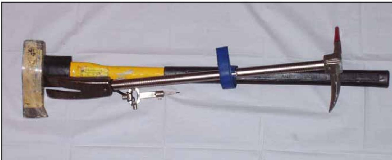
eine sehr gute Brechstange mit verschiedenen Hebelmöglichkeiten. Aber auch als Türramme ist das Haligan Tool für normale mittelschließzylinder verschlossenen Türen ausreichend.
