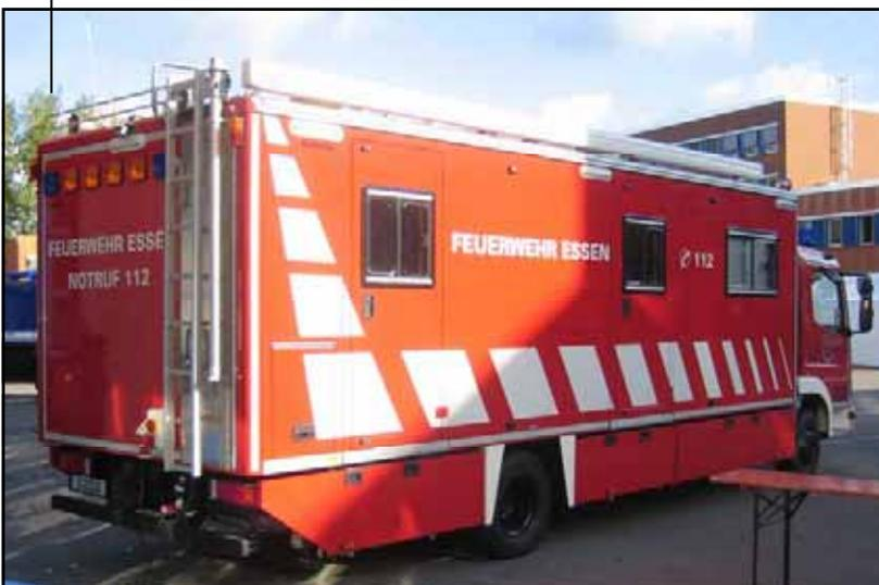
*Beispiel eines neuen, größeren ELW 2/3 auf der Basis eines LKW*
