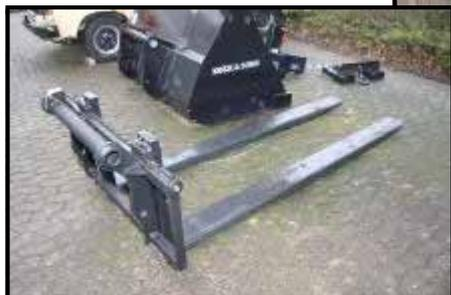
Der Teleskopstapler lässt sich mit verschiedenen Anbaugeräten vielseitig einsetzen: Bild oben Palettengabel, Erdschaufel und zwei unterschiedliche Kranhaken
