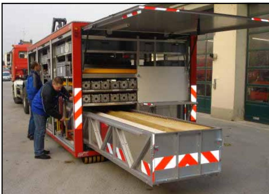
Abstützmaterial ist über eine große Klappe am Heck leicht zugänglich
