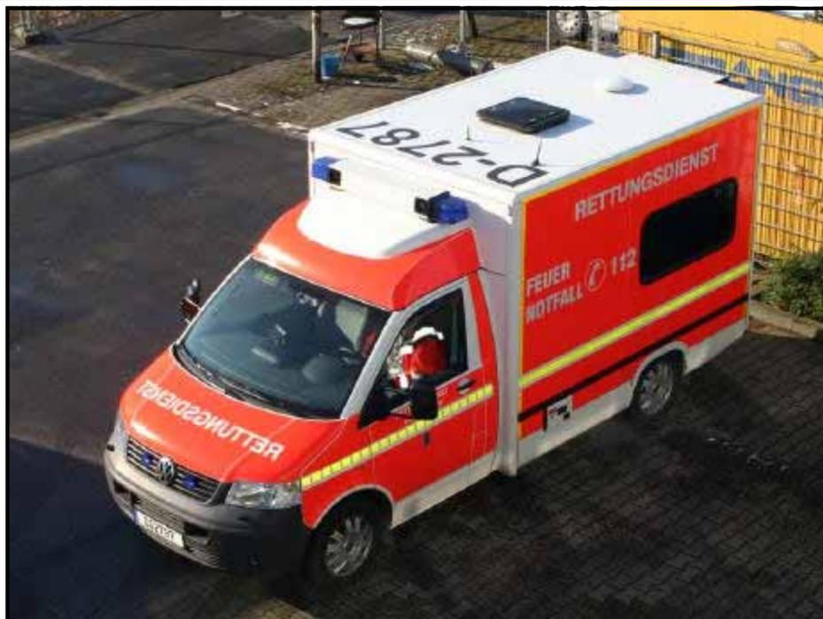
Neue KTW auf Basis des VW T 5 mit Kofferaufbau
