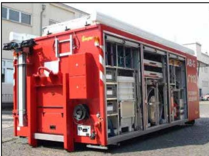
Der dritte wird mit einem Gerätesatz zur Dekontamination von Geräten ausgestattet und bei der Löschgruppe Umweltschutz stationiert.
