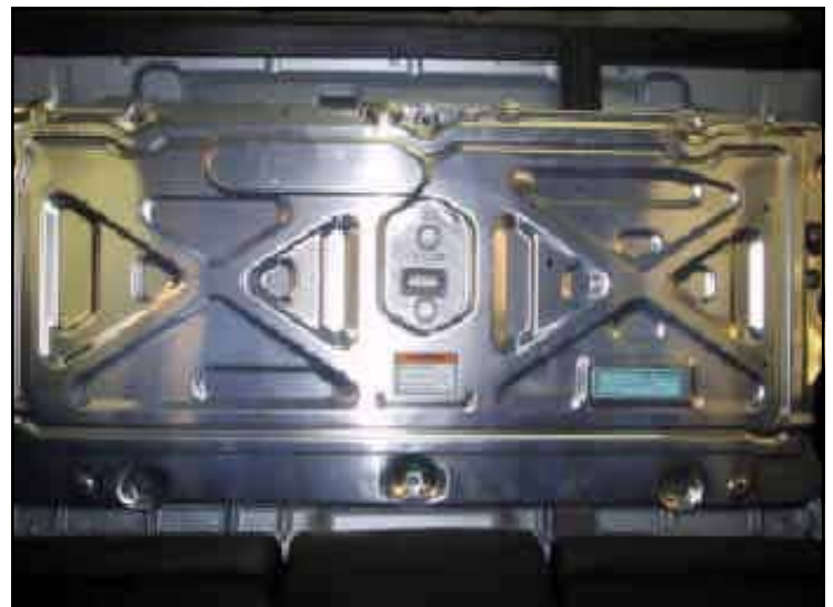
Einbauort der Hochspannungsbatterie (Rücksitzlehne ausgebaut und Abdeckung der IMA-Einheit montiert.)
