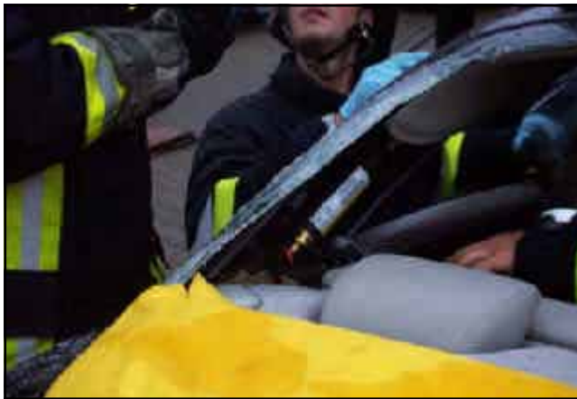
Abbildung 14: ... und der Gasgenerator freigelegt.
