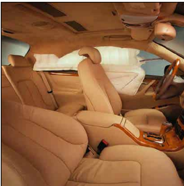
Abbildung 5: Die umfangreiche Airbagausstattung besteht aus mehrstufigen Fahrer- und Beifahrerairbags, Seitenairbags in den Türen und Kopfairbags (Foto: Mercedes-
