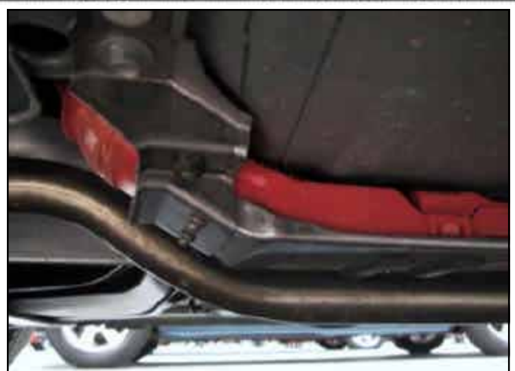
Orangefarbene Hochspannungskabel am Fahrzeugboden
