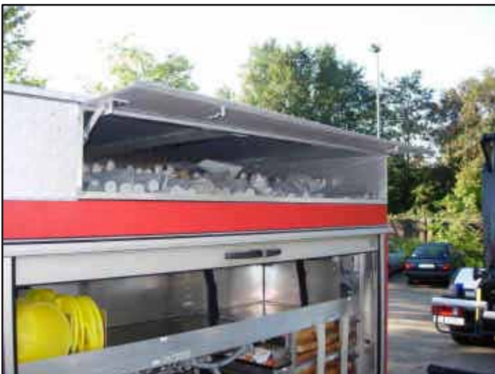
Bild 1: Der neue Dachkasten mit den dort gelagerten Krankentragen
