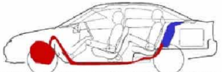
Einbauort der Hochspannungsbatterie (Rücksitzlehne ausgebaut und Abdeckung der IMA-Einheit montiert.)
