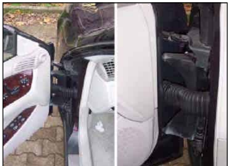
Abbildung 3: Das Türscharnier hat eine komplexe Konstruktion, da die Tür vor dem Öffnen erst einige Zentimeter nach vorne schiebt. (Fotos: Jörg Heck)
